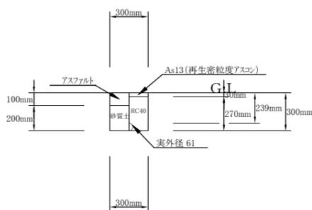
そのB 01: VLGφ50撤去 (掘削・埋戻し) 1/20
