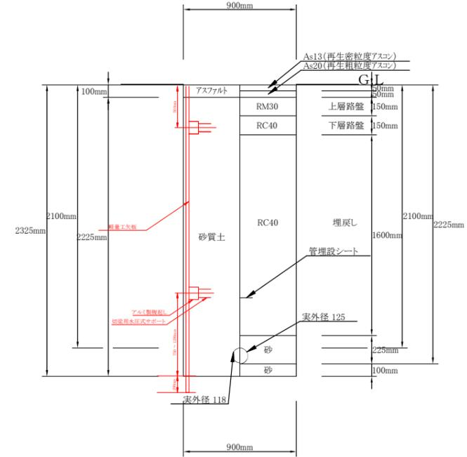
そのB 02: EF-PEPφ50既設連絡 (掘削・埋戻し) 1/20
