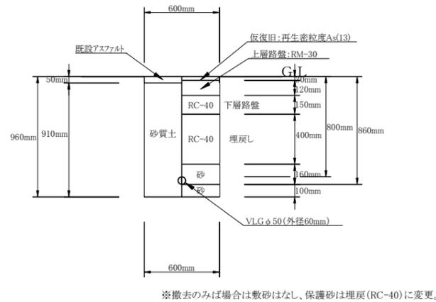
※撤去のみ場合は敷砂はなし、保護砂は埋戻(RC-40)に変更。
