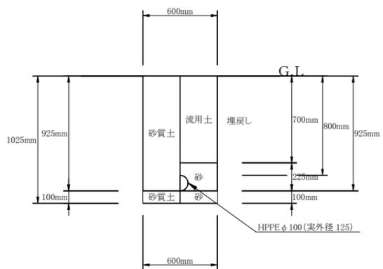
既設Co撤去断面図 S=1:10
