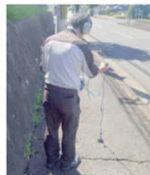
▲漏水可能性箇所の現地調査
